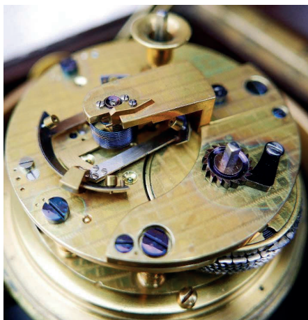
Skeppskronometer no 2565, signerad: "Hewitt & Son, London", tillverkad ca 1861 med "Hartnup Balance". (2)
