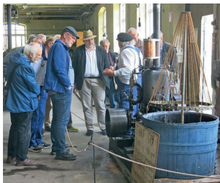
Tändkulemotor 8 hk 1914, går på torskleverolja, smör eller vad man haver.
