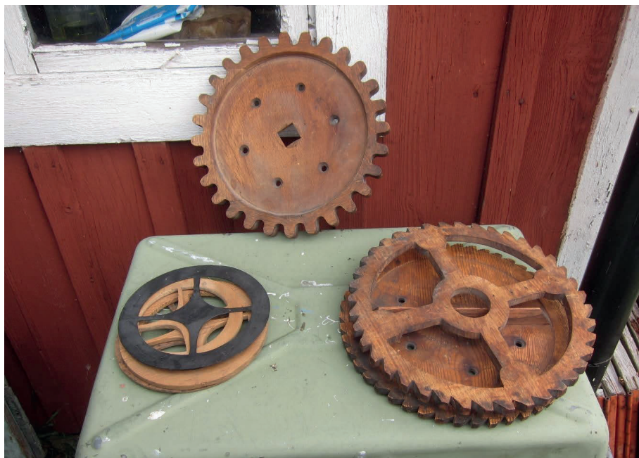
Från Samuel Svenzons (1812-1895) urmakarverkstad/smedja i Östergötland. Trämodeller för gjutning av hjul till tornur. Från utflykt med DGUV Östergyllen 2012. Samuel Svenzon var William Samuelius farfar se sid 50 och Arg 2. Foto Eric Read.
