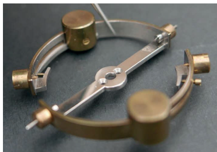
"Improved ordinary balance" (ver. 2) Balansens skänkel har den tyska balanstillverkaren Griessbach:s märke. Kullbergs balanser var ej skyddade av patent.
