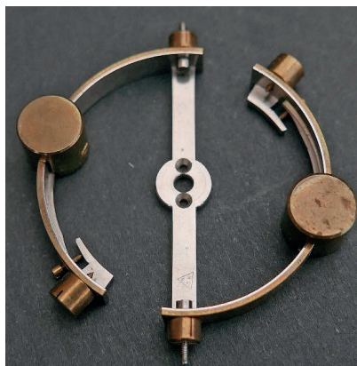
"Improved ordinary balance" (ver. 2) En kronometerbalans utan verk tillverkad av firma Griessbach i Glahütte.
