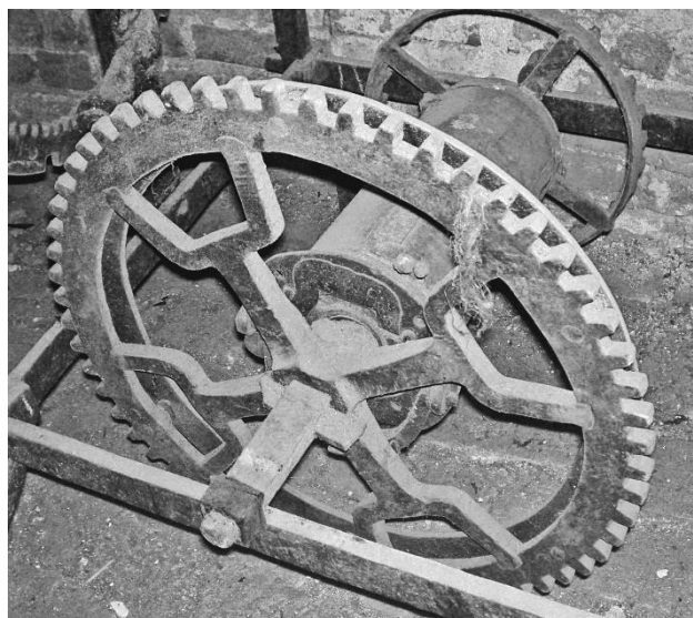
Slagverkets linhjul och kugghjul med 60 tänder. Kugghjulet har ålderdomliga ekrar. Kanske det är från det första uret. Det har 6 lyftstift och har därför gått 26 varv per dygn. Foto E. R. 2006
