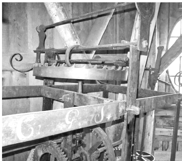
Del av urverk från 1685 i klocktornet på Steninge slott. Johan Kochs ombyggnad innebar att han gjorde ett kronhjul med driv mot linvalsens kugghjul och ett horisontellt steghjul för spindelgång med driv mot kronhjulet, som på bilden. Pendeln har hängt bakom uret emellan de två utåtsvängda plattjärnen. Foto Eric Read 2010.
