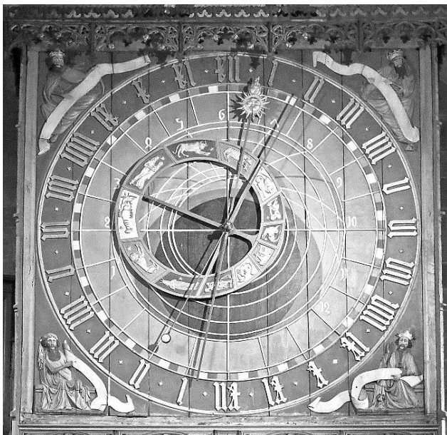
Urtavlan på astronomiska uret i Lund som är av den äldre typen. Timvisaren visar på 12:45 och den ligger över stjärnbilden våduren på Zodiak-tavlan. Nertill vid II ser man att det är fullmåne. Foto Eric Read 15-04-01.
