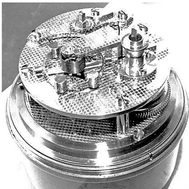
Kronometerverket som Sven Sandström tillverkade i Glashütte.
