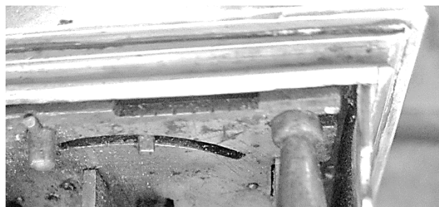
Ur 3. Uret är ombyggt till en ny balans med fjädderruckning. Den gamla markeringen för svinborstsruckning syns i kanten framför den nyare ruckningen.
