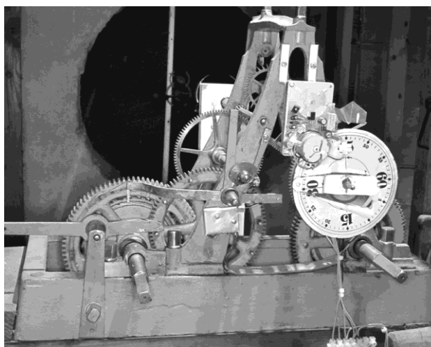
Tornuret, levererades från Linderoths fabrik till Lagerlunda gård 1877. Nu ombyggt till elektrisk drift.
