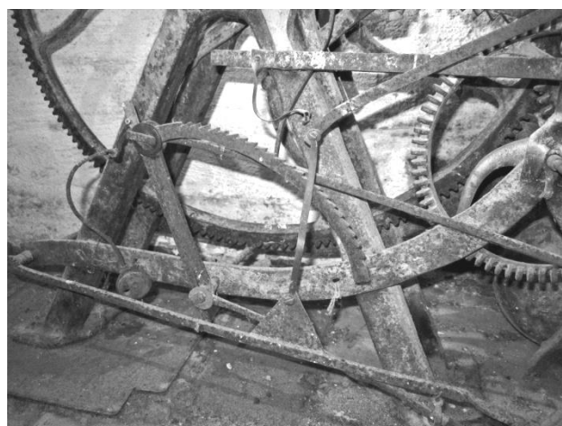
Urverkets trappslag. Stängen fäst till vänster på trappan går till staffeln. Se bilden ovanför.
