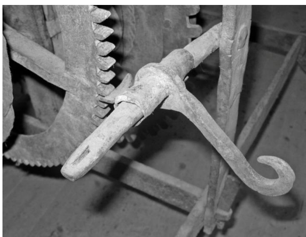
En liten anordning som använts för att hålla igång det gamla tornuret i S:t Olofs kapell. Nu i Adolf Fredriks kyrka i Stockholm. Uret användes från 1690 till 1782. Om anordningen är från 1600-talet är osäkert. Foto E. Read 2008.
