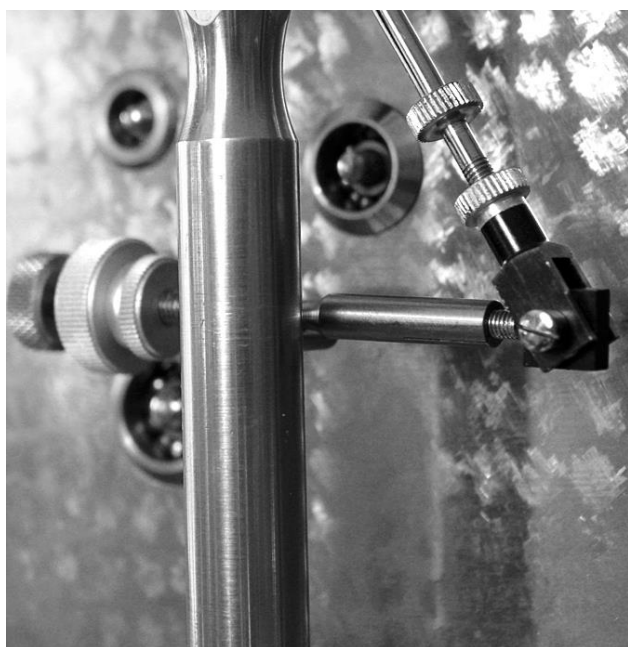
Det av Ove Haglund omarbetade fästet som släpper från pendelstången, om uret skulle stanna, och därmed förhindrar att steghjulet slås sönder av gånghaken.
