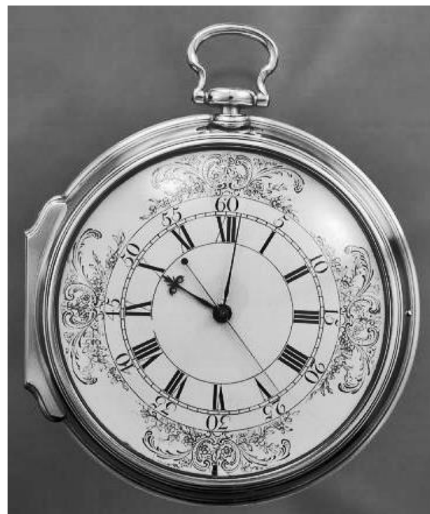
Harrisons Chronometer H4. Urets diameter är 5.2 inches ungefär 12,7 cm. Bild på nätet.
