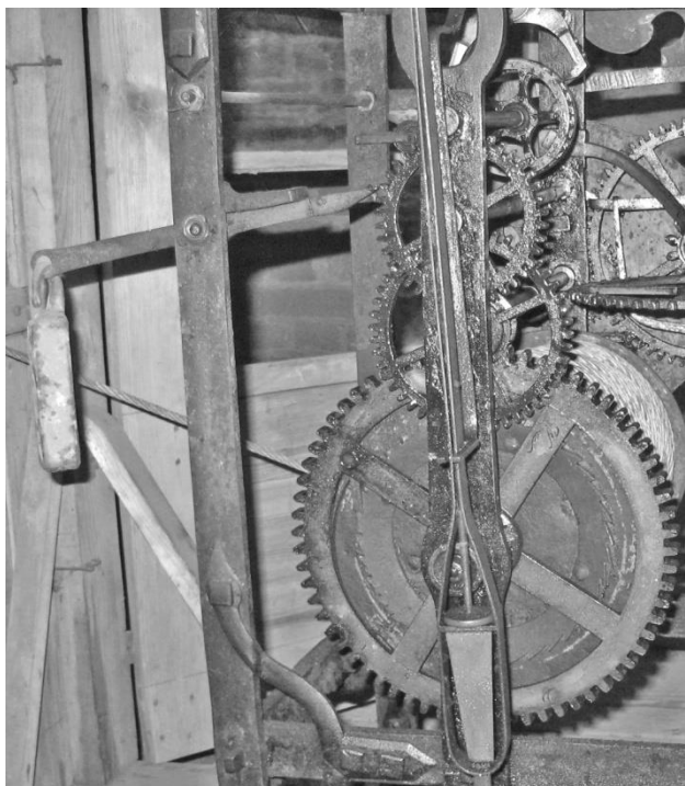
Tornur i Vaksala kyrka av Marmén 1795. Hävarm med stift som driver mellan två tänder på mellanhjulet närmast steghjulet då uret dras upp. Tyngden som driver hjulet syns längst till vänster. Foto E. Read 2008
