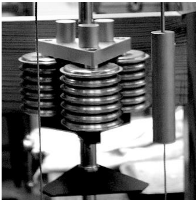
Lufttryckskompensatorn på Enghoffs ur med vikter ovanpå barometern. Under kompensatorn är en triangulär platta där vikter kan ställas för att finjustera svängningstalet.
