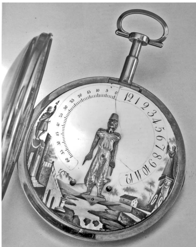
Bras-en-l'air. Då pendanten pressas ned lyfter figuren armarna och pekar ut tiden.
