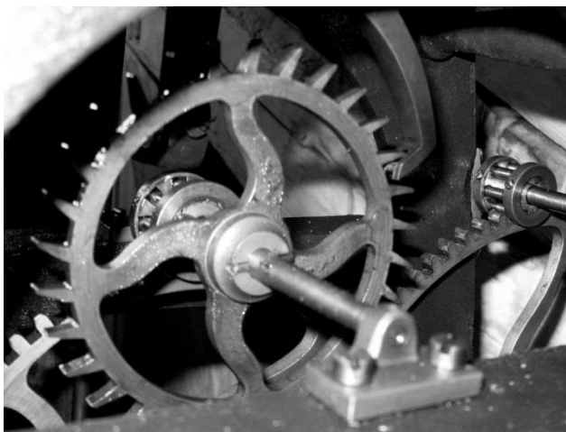
Steghjulet som går i högervarv och gånghaken som har inslipade karneolstenar.
