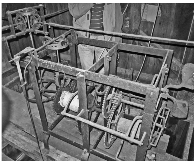
Tornuret med gångverket till vänster. Uret har byggts om till spindelgång med pendel. Foto Eric Read 2010-09-04.
