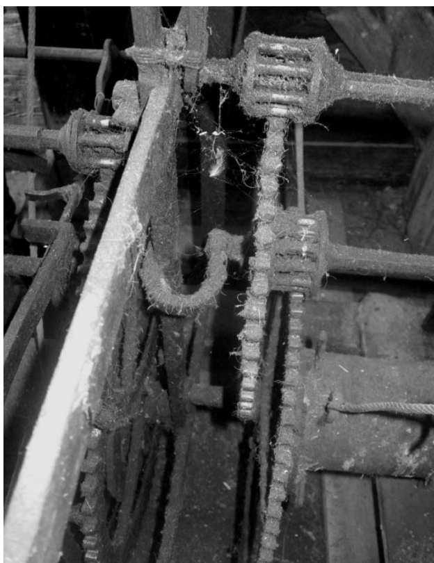
Gångverkets linhjul, mellanhjulet och driven på gånghjulsaxeln. Då uret hade stångbalans satt ett steghjul där mellanhjulet sitter och spindeln med stångbalansen stod vertikalt bakom steghjulets fäste. Foto Eric Read 2011-09-03.
