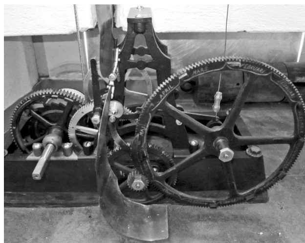
Kalenderns drivverk med "slagskiva" för datum-ändring. Vid månadens slut går det vidare till nästa månad och tar på detta sätt hänsyn till månadernas längd.
