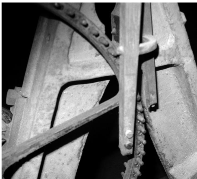
Ankare och steghjulet med stiftgång. Den bakre stångens nedre del är avbruten.
