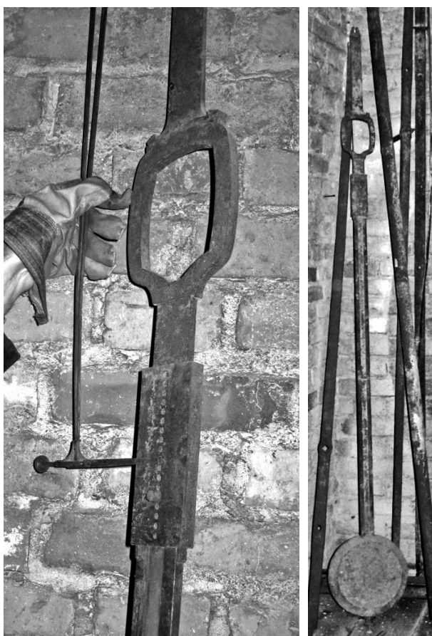
Pendeln och pendelförararmen. Något stämmer inte. Pendelförararmens längd stämmer inte med fästet på pendeln som sitter alldeles för högt upp. Lägg märke till att pendeln skall hängas upp på stången som sticker upp ovanför verket.
