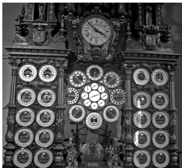
Verités ur i Becanson har ett stort antal urtavlor som visar lokal tid i olika världsdelar, tidvattnen i franska hamnar, kyrkliga högtider, månens faser, solförmörkelser och skottår och tar hänsyn till att det är skottår 2400 och 2800.
