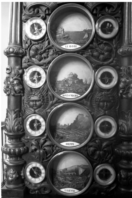
Fyra av de 8 urtavlor som visar tidvatten i franska hamnar. Urtavlorna till vänster visar tiden för flod, i mitten bilder med rörliga båtar och vågor och till höger visas tidvattnets höjd baserat på månens faser.
