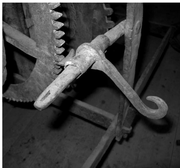
En gammal kontraspärr på 1600-talsuret i Adolf Fredriks kyrka. På kroken skall det hänga en vikt så att uret inte stannar när det dras upp.
