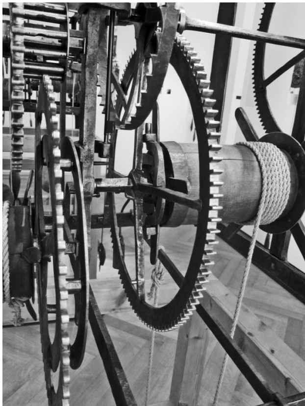
Lägg märke till spindelns nedre fäste, det stora antalet tänder på linhjulet och avståndet mellan
