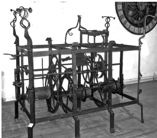
Tornur av Lorenz Liechti från 1529 med typiska gotiska hörnstolpar med "vattenutkastare", som på gamla järnur. Men vad kan man få fram om åldern av hörndekorationerna?
