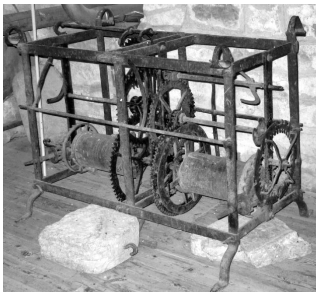
Tornurverk med pendel mellan gång- och slagverken. Husaby kyrka. Tidigt 1700-tal.
