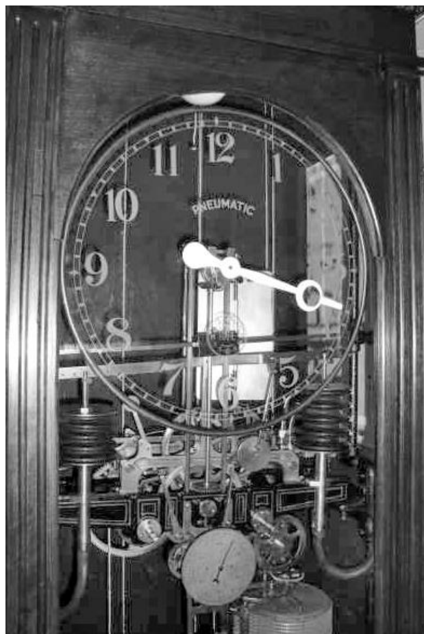
Hahls huvudur där man kan se kolvarna som reglerar slavuren.
