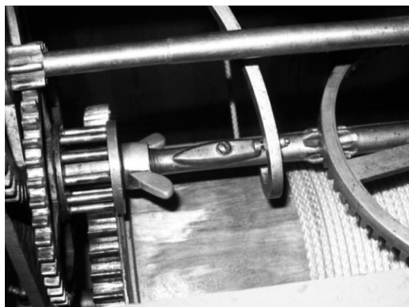
Driv för visarhjulen som är smidd som en del av axeln. Den lilla klacken på axeln lyfter utlösningssarmen för slagverket
