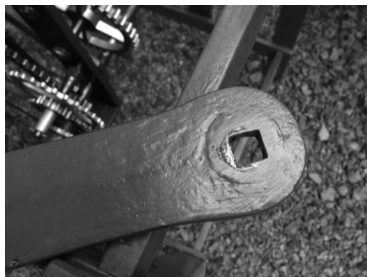
Axlarna som går ut till visarna lagras i fyrkantiga hål.
