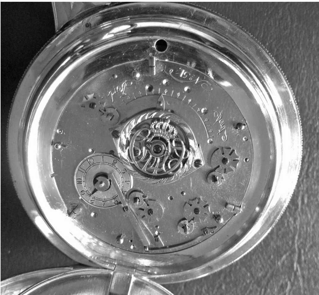
Reseur nummer 51, 1833. På föregående sida, fodralet och reseuret intill ur 104. På denna sida boetten med Johan Nybergs namn, och den av Jöns Dahlgren drivna boetten. På nedersta bilden syns bl. a. malteserkorsen vid de fyra uppdragen och väckningsinställningen. Här är Sent skrivet spegelvänt och Fort rättvänt.
