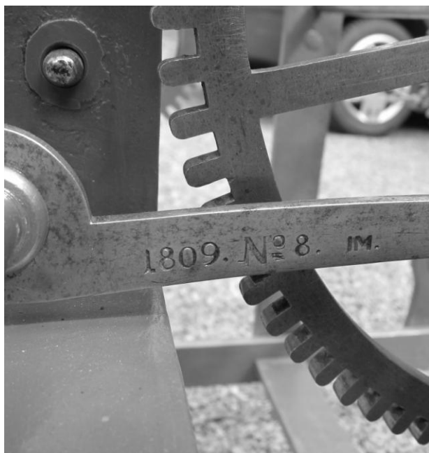
Verkets årtal, nummer och Johan Marméns initialer finns på slagverkets utlösningsarm.
