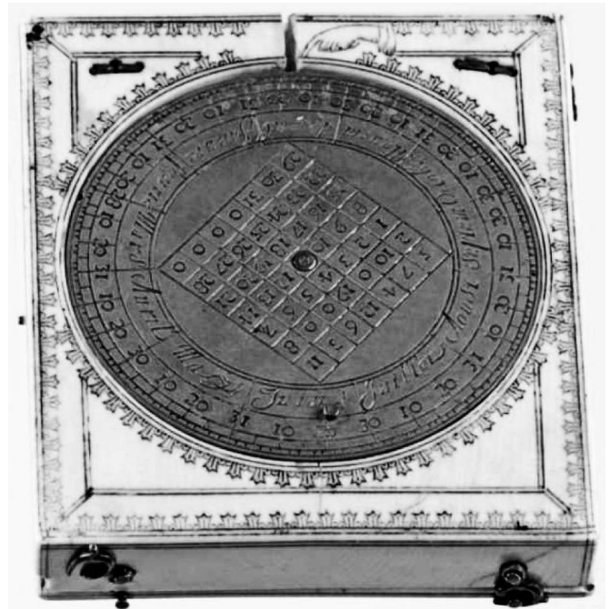
Solurets undersida med evighetskalendern och den vridbara årstidsskalan för inställning av den ellipsformade skalan under kompassnålen.(SSM)
