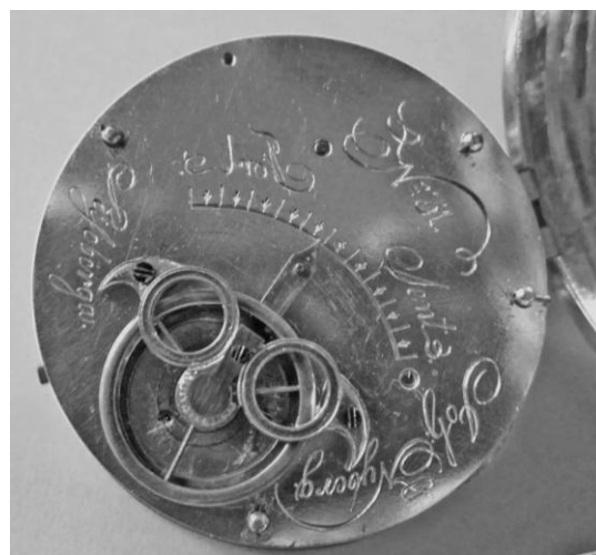
Ur nummer 31 1825. "Glasögonklove" Fort är skrivet spegelvänt för att få sym- metri med Sent. Uret saknar slagverk.
