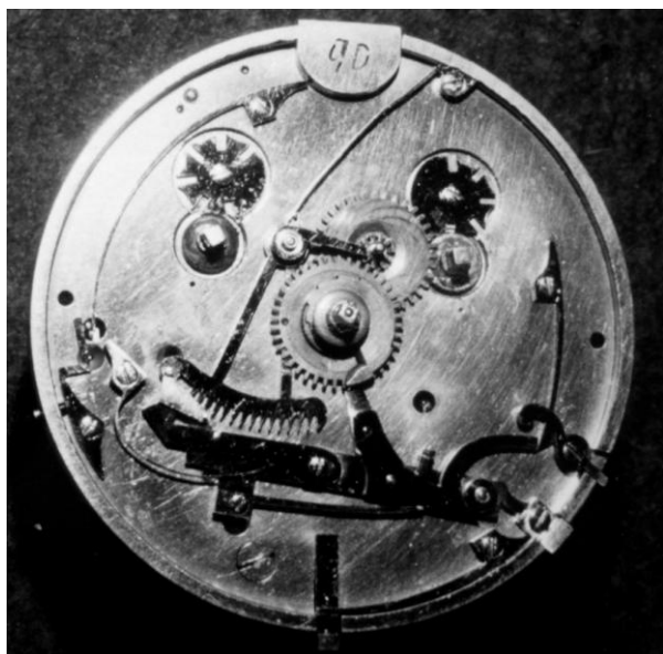
Ur nummer 90 1839. Uret har jämfört med övriga ur en enkel oroklove. Slagverket syns på den nedre bilden.
