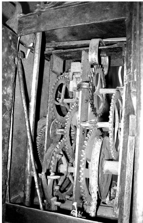
Figur 16. Gammalt ur i Västerviks museum från omkring 1640 som försetts med senare urtavla och släphaksgång. Slagverkets linhjul är fäst i bommen med en kil.
