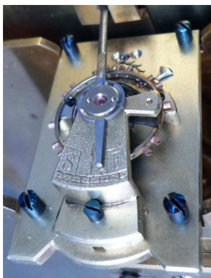
Urverk, 90x90x33 mm (h x b x d), av god kvalitet med profilerade verpelare och blankpolerade skruvar av stål. 8-dygns gångtid.
