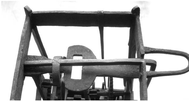
Figur 19. Ur tillverkat för släphaksgång med gånghaken placerad grensle över den övre skenan.
