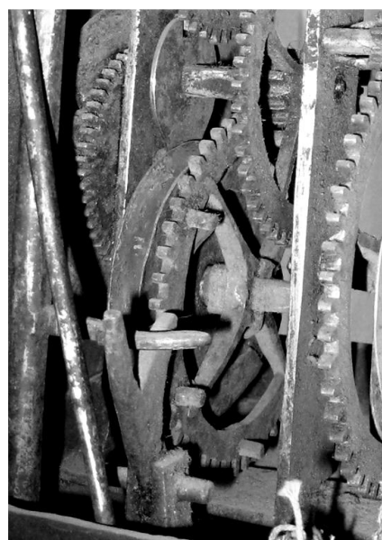
Figur 16. Gammalt ur i Västerviks museum från omkring 1640 som försetts med senare urtavla och släphaksgång. Slagverkets linhjul är fäst i bommen med en kil.
