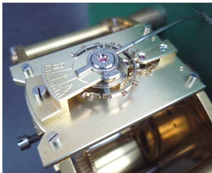
Gångpartiet med 13 rubiner inkl. motstenar för gånghjulets och ankarets nedre axel- tappar. Fint polerad ruckarm. Detta utförande återfinns även i andra skeppsur.
