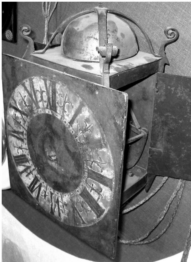
Figur 16. Gammalt ur i Västerviks museum från omkring 1640 som försetts med senare urtavla och släphaksgång. Slagverkets linhjul är fäst i bommen med en kil.
