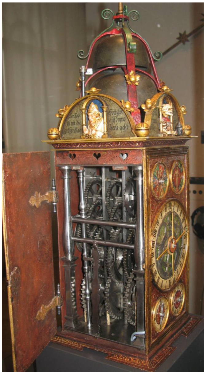
Figur 8. Till vänster, astronomiskt loddrivet ur av smidesjärn tillverkat i Schaffhausen 1567 och till höger ett järnur från Sydtyskland 1480-90. Hjulbalansen är inte original och urtavlan var under renovering då bilden togs. Kellenbergersamlingen i Winterthur Schweiz.
