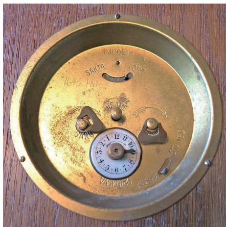
Bild 9. Den bakre skyddsplåten på sparur typ 1. Foto Eric Read.
