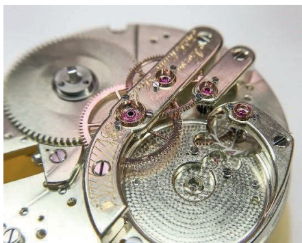
Fig. 3. Verket efter rengöring och delvis ihopsatt. Även undersidorna på alla bryggor och klover är dekorerade med perlage – det vill säga små slipade rundlar.
