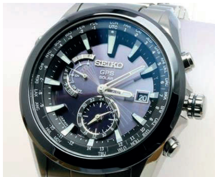
Astron GPS Solar från 2012, utnyttjar solen för energin och GPS för precisionen.
