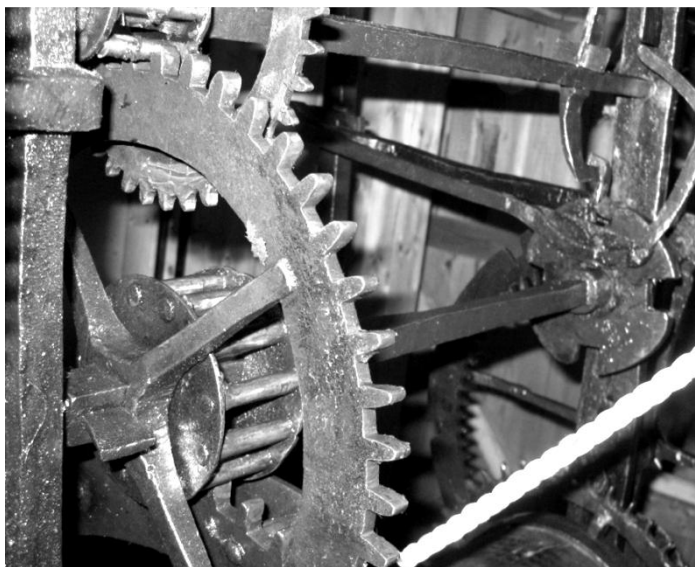
Figur 14 Gammalt mellanhjul och driv på bommen med hjärtat. Hjulet är kilat vid bommen på ålderdomligt sätt.
