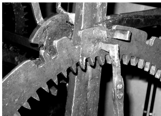
Figur 12 Tappen där slagskivan slår ett slag. Inga andra slagskivor har en sådan tapp.
