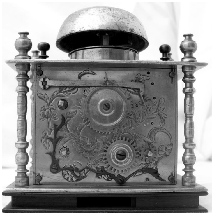
Gångverket med fjäderhus och snäcka. Baksidan med slagskiva och ifallsarm. Lyftarmen saknas. Det saknas också ett spärrhjul på fjäderhusets uppdragning.
