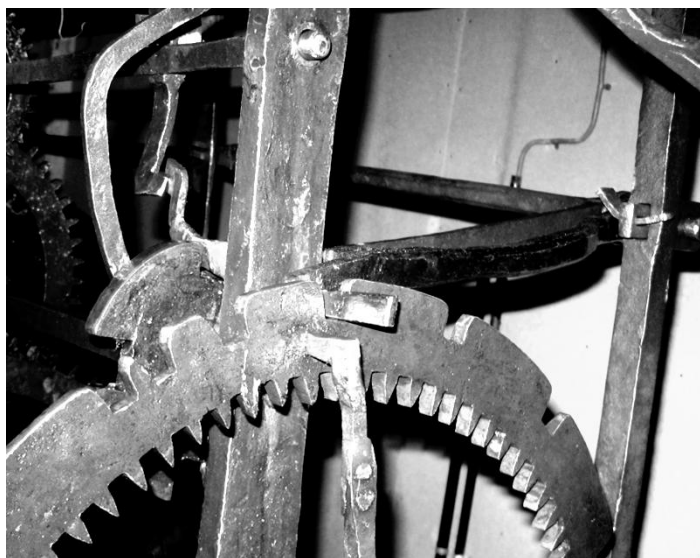
Figur 16 Ifallsarmens gaffel som ligger i slagskivan närmast och i hjärtat bakom stolpen.
