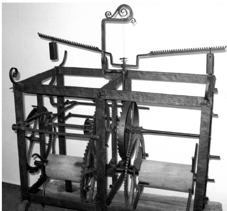
Figur 5 Tyskt tornur från 1550-talet med stångbalans av samma typ som har funnits på Rådhusuret och med handtag på valsarna för uppdragning. (Uhrenmuseum Bad Grund Harz.)
