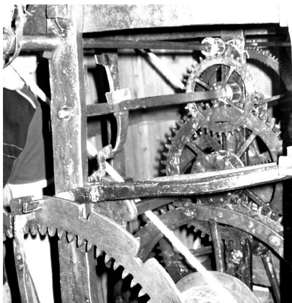
Figur 15 Slagverkets utlösningssanordning med "gaffeln" som ligger i slagskivan och hjärtat samt stången som går till lyftarmen. Hålet för den äldre utlösningen av slagverket syns i skänkeln på gångverkets stora kugghjul.
