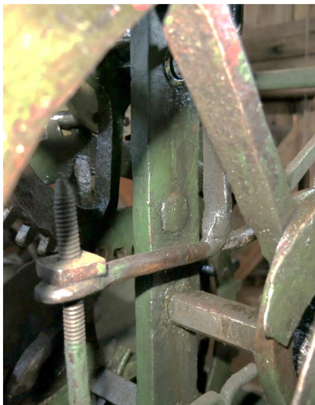
Där niten sitter på gruvuret (mitt i bilden) har det tidigare suttit en bygel med lager för spindelstängens, som på bilden till höger.
