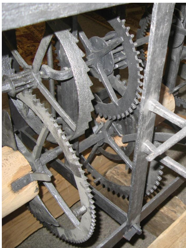
Steghjulet för spindelgång på museets ur. Man ser också fästet för den arm som skulle utlösa slagverket mot stiftet på linvalsens hjul.
