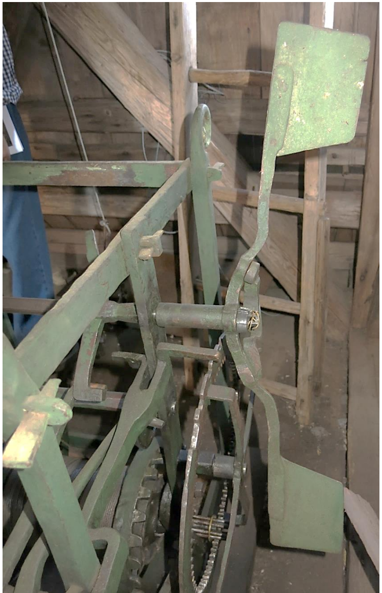
Bilden till vänster. Museets ur med slagskiva och handtag på linvalsen för uppdragning av loden. Till höger gruvans ur med slagskiva och vindfång.
