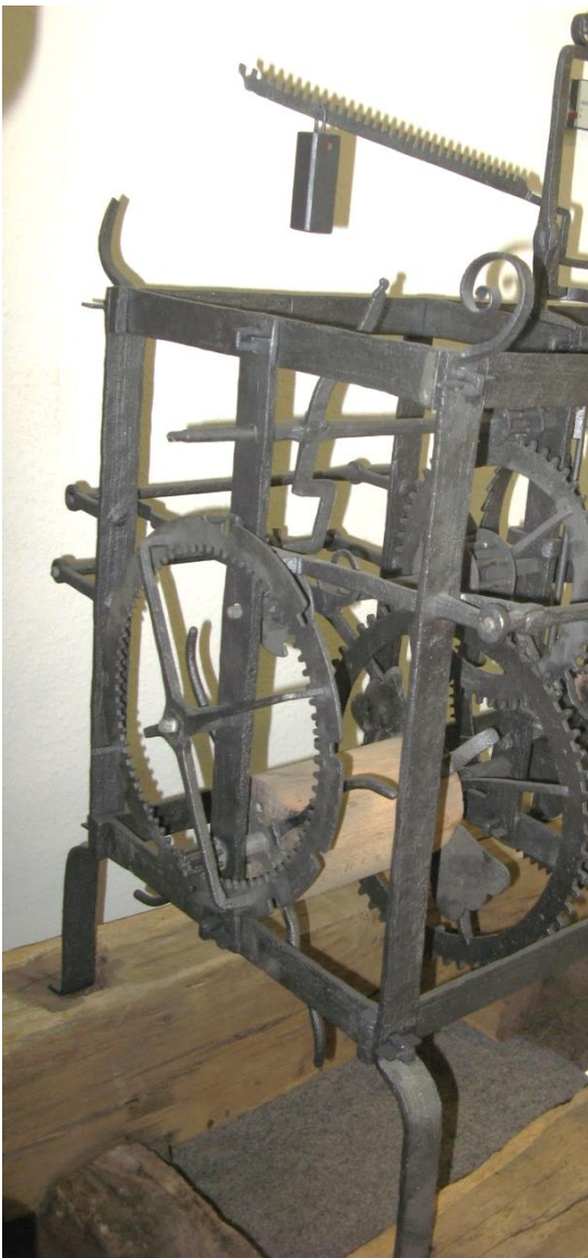
Bilden till vänster. Museets ur med slagskiva och handtag på linvalsen för uppdragning av loden. Till höger gruvans ur med slagskiva och vindfång.
